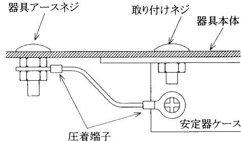
2. バネ板などで固定された取り付けネジは、器具にアースされていますので安定器ケースをその取り付けネジにアースすれば接地がなされます。
