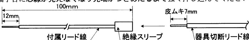
※ 絶縁スリーブは絶縁被覆付き圧着スリーブ（BTB形、電線抱合容量1.25mm<sup>2</sup>）を使用しております。
