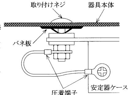
3. 安定器ケースと取り付けネジとの接続にアース座金を用いているものがあります。バネ板などで固定された取り付けネジ側に、アース座金を用いていれば接地がなされます。
