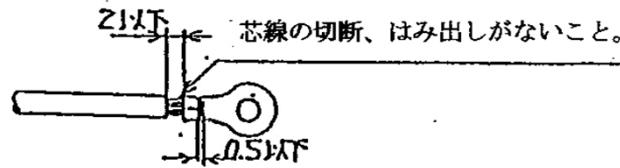
圧着工具は専用工具でかしめてください。
