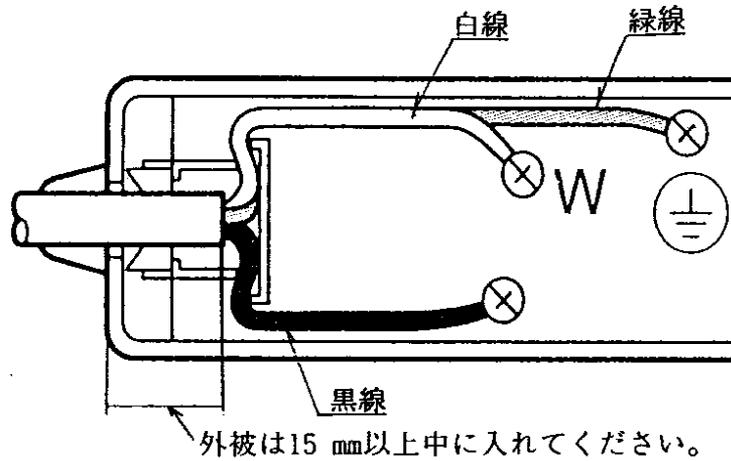
(3)端子ねじは0.8 N・m～1 N・mで締め付ける。
