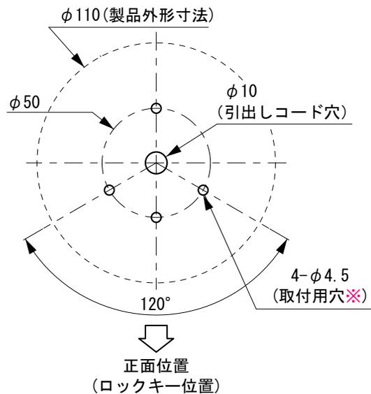
※ ボルト・ナット/小ネジなど使用の場合、長さは(8mm+取り付ける板厚)以上をお使いください。
