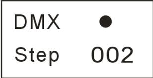
ボタンを押します。これで 1 つ目のステップが記録され、ディスプレイには次のステップである” STEP 001” と表示されます。また、この際ステップとステップとの間にインサートすることも可能です。1 つのバンクに最大 999 ステップを記録することができます。
