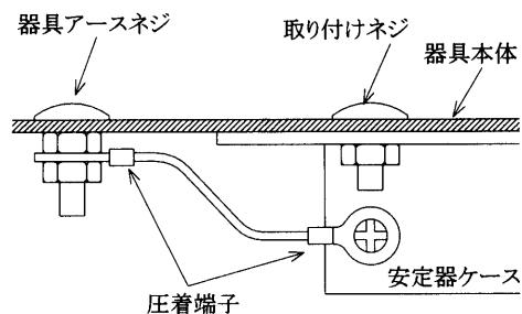
2. バネ板などで固定された取り付けネジは、器具にアースされていませんので安定器ケースをその取り付けネジにアースすれば接地がなされます。
