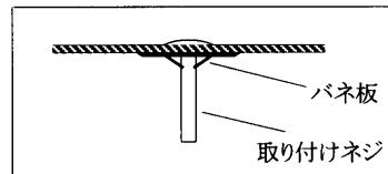
2. バネ板：安定器の取り付けネジがバネ板で器具に固定されているものがある場合そのまま使用してください。
