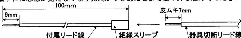
※ 絶縁スリーブは絶縁被覆付き圧着スリーブ（BTB形、電線抱合容量1.25mm<sup>2</sup>）を使用しております。
