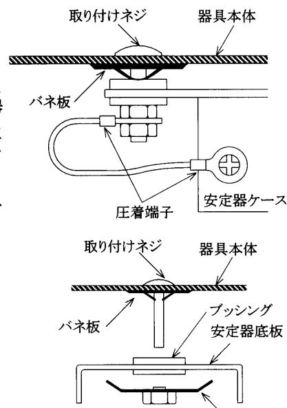
3. 安定器ケースと取り付けネジとの接続にアース座金を用いているものがあります。バネ板などで固定された取り付けネジ側に、アース座金を用いていれば接地がなされます。
