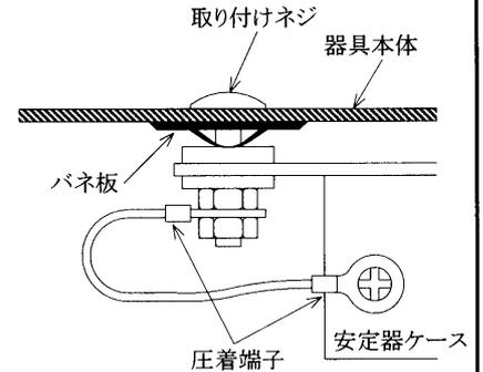
3. 安定器ケースと取り付けネジとの接続にアース座金を用いているものがあります。バネ板などで固定された取り付けネジ側に、アース座金を用いていれば接地がなされます。アース座金については、お問い合わせください。
