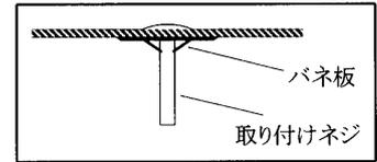
2. バネ板：安定器の取り付けネジがバネ板で器具に固定されているものがある場合、そのネジと穴をそのまま使用してください。
