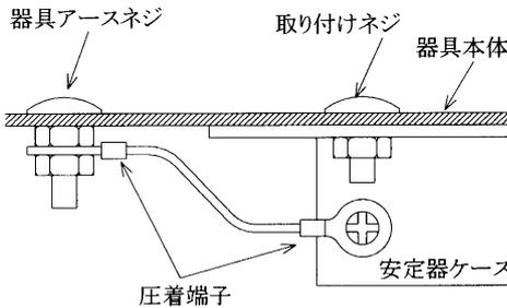
2. バネ板などで固定された取り付けネジは、器具にアースされていますので安定器ケースをその取り付けネジにアースすれば接地がなされます。固定ネジ側でアースを取ってください。
