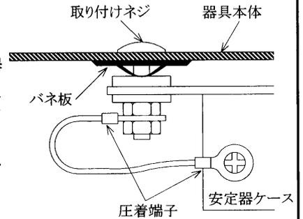
3. 安定器ケースと取り付けネジとの接続にアース座金を用いているものがあります。パネ板などで固定された取り付けネジ側に、アース座金を用いていれば接地がなされます。アース座金については、お問い合わせください。
