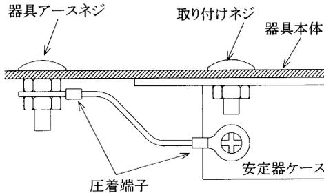
2. パネ板などで固定された取り付けネジは、器具にアースされていますので安定器ケースをその取り付けネジにアースすれば接地がなされます。固定ネジ側でアースを取ってください。
