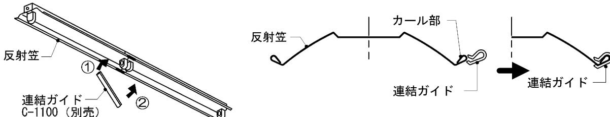
※反射笠のカール部に連結ガイドを差し込み取り付けてください。
