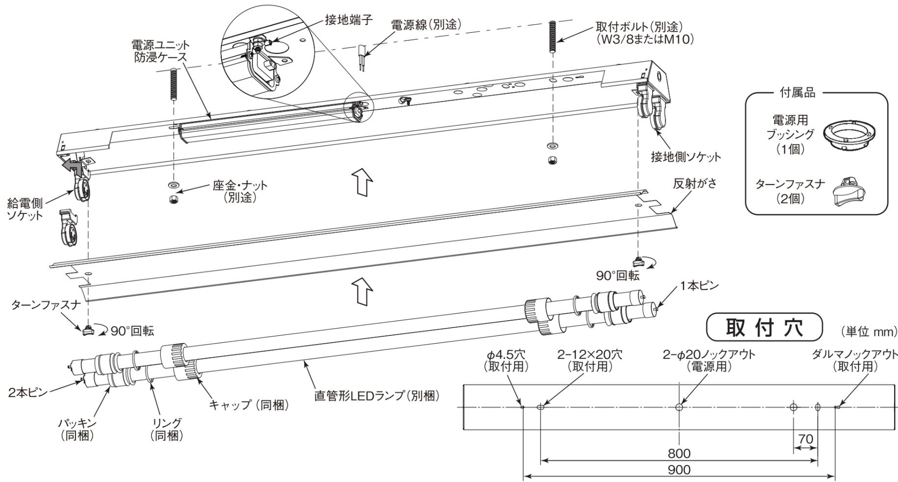
**5 反射がさを取付ける**
