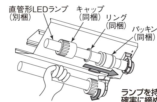
ランプを持ってキャップを確実に締め付ける
