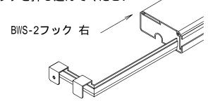
② ブラケットの間隔に合わせてブラケットフックを セットします(片側で最大50mmまでスライド可能)
