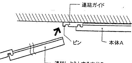
**△ 不完全な場合とリリースボタン以外を押した場合は、接続不良による発熱、火災、感電の原因となります。**
