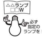
ランプ交換の際には、本体表示および取扱説明書にしたがって指定されたランプを使用してください。指定以外のランプを使用すると火災の原因になります。
