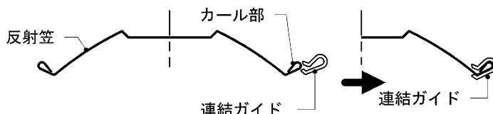
※反射笠のカール部に連結ガイドを差し込み取り付けてください。
