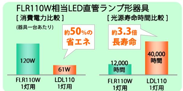
工場の生産ラインで使用していたFLR110W蛍光灯器具は、経年劣化による故障も多くなり、器具更新にあわせてより省エネルギーがはかれるLED器具への交換が行われました。
