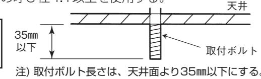
注) 取付ボルト長さは、天井面より35mm以下にする。
