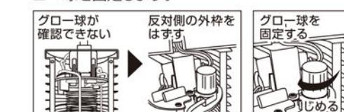
⑦グロー球の交換が終わりましたら、外した外枠を正しい位置に戻します。
