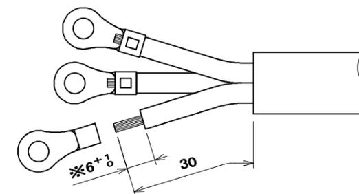
※被覆剥き寸法の6<sup>+1</sup><sub>0</sub>は2mm<sup>2</sup>のもので、3.5mm<sup>2</sup>は7<sup>+1</sup><sub>0</sub>
