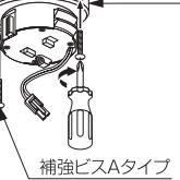
2.補強ビスAタイプを通しながらプラグにシーリングプレートを取り付け、左に回して図Aの位置に仮止めした補強ビスAタイプがくるようにし、ドライバーでしっかりと締めてください。
