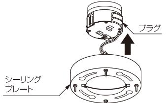
天井配線器具によって取り付け完了時のシーリングプレートの位置が違います。
