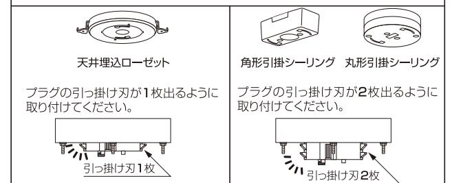
この時、回転防止ツメにプラグの引っ掛け刃が接触しないようにしてください。
