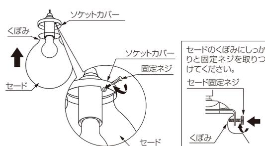
ネジを固定した後に再度、セードがしっかりと固定されているか確認してください。
