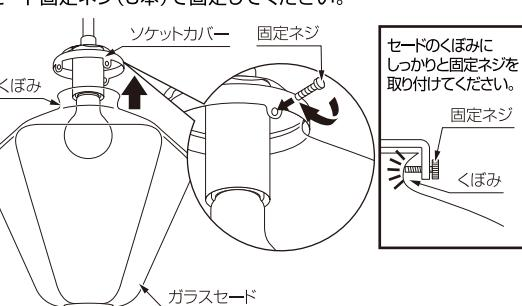
△ ネジを固定した後に再度、ガラスセードがしっかりと固定されているか確認してください。
