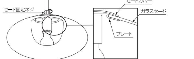
**警告** ネジを固定する前に、プレートにガラスセードが乗っているか、ガラスセードがプレートと平行になっているか確認してください。ネジを固定した後は再度、ガラスセードがしっかりと固定されているか確認してください。
