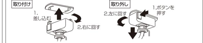
取り付け及び取り外しの際に、無理な角度で回したり、強い力で扱るとプラグが破損します。十分注意してお取り扱いください。
