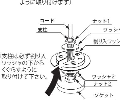
3 セード穴にプラグから順に通していく、割り入ワッシャの段差がセード穴に合わせるように組み立ててください。
