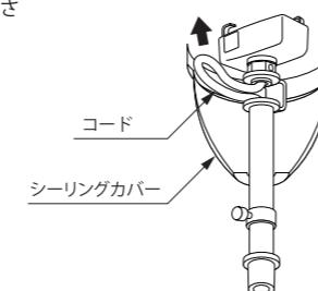
必ずチェーンの長さよりもコードの方が長くなるように調節してください。
