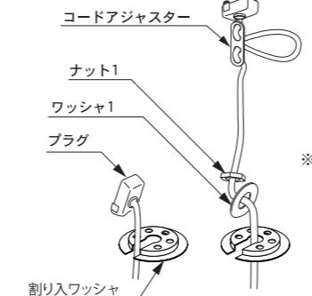
2 ワッシャ1を支柱にセットし、ナット1を右に回して固定してください。(ワッシャ1,2で割り入ワッシャをはさむように取り付けます)
