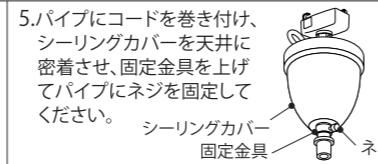
5.パイプにコードを巻き付け、シーリングカバーを天井に密着させ、固定金具を上げてパイプにネジを固定してください。シーリングカバー 固定金具 ネジ
