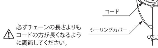
必ずチェーンの長さよりもコードの方が長くなるように調節してください。
