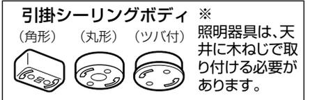
⚠警告 下記のような配線器具には取り付けられません。火災・感電・落下によるけがの原因となります。
