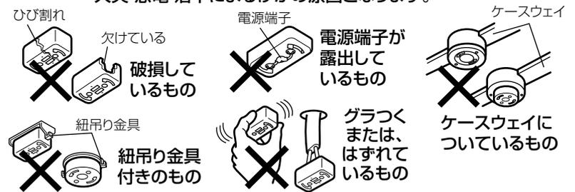
電気工事店(有資格者)に依頼して配線器具を交換してください。一般のかたの電源工事は禁止されています。
