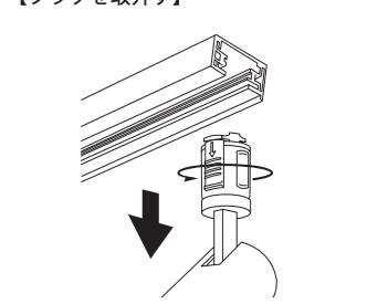
※ダクトレールには向きがあります。取付けの方向を間違えると点灯しない場合があります。点灯しない場合は取付けの方向を再度ご確認ください。
