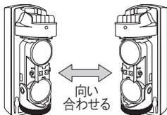
投光器と受光器の照準器をのぞきながら、相手側のセンサが中央にくるように目視調整します。センサが中央から外れている場合は再調整してください。
