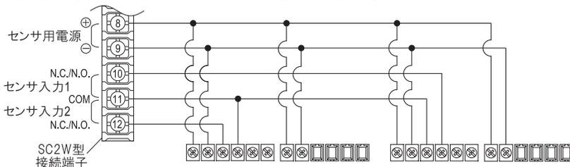
※この配線例は、方向判別機能を使用する場合の配線例です。方向判別機能を使用しない場合の配線や出力機器の配線、コントロールボックスの詳細設定などについては、コントロールボックス(SC2W型)の取扱説明書を参照してください。
