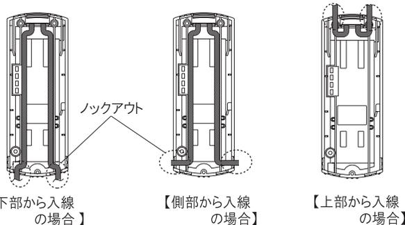
※上部、下部、側部のノックアウトを必要な所だけニッパー等で破って配線してください。
