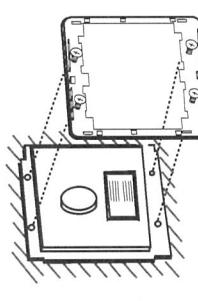
プレート枠(同梱品)を付属ネジで取付板につけます。
