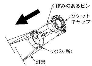
ソケットキャップを矢印の方向へまっすぐに差し込み、灯具に確実に取付けてください。
