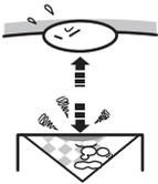
器具と被照射面の距離は本体表示および取扱説明書にしたがって十分な距離をとってください。指定距離より近すぎると、被照射物の変色・変質をおこすばかりか火災の原因になります。
