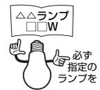
ランプ交換の際には、本体表示および取扱説明書にしたがって指定されたランプを使用してください。指定以外のランプを使用すると火災の原因になります。
