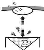
器具と被照射面の距離は本体表示および取扱説明書にしたがって十分な距離をとってください。指定距離より近づけると、被照射物の変色・変質をおこすばかりか火災の原因になります。
