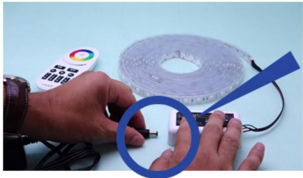
LEDテープを点灯させた状態でコントローラーに供給する電源をOFFにする。
