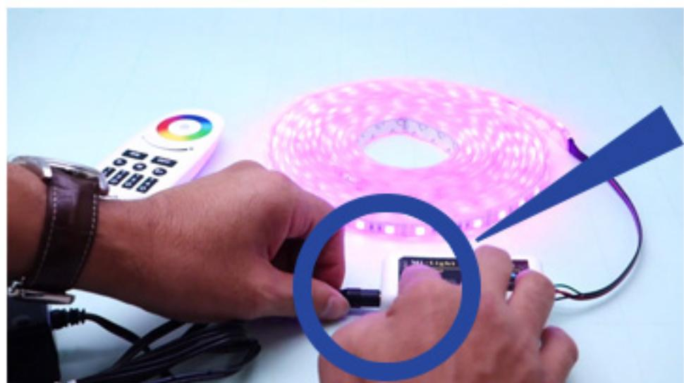
マルチゾーンコントローラーに供給する電源をONにする。
