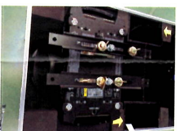
吊金具を機材に取り付けた状態
