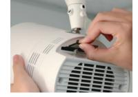
カードの表を上にして、角が欠けた方からSD カードスロットにしっかりと挿し込みます。
