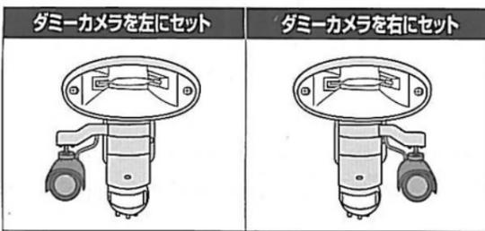
● ダミーカメラの角度調整をした後は、ナットがゆるんでいますので、ナットをしっかりと締めて固定してください。
