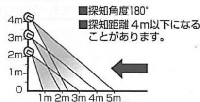
\*センサーに向かって左右に横切った場合は敏感に反応しますが、センサーに向かって直進した場合は、極端に探知が鈍くなります。図1、図2の条件に合う場所に取付けてください。
