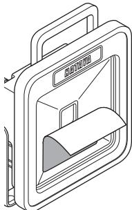
LED光源が眩し過ぎる場合は防眩シートを前面ガラスにLED発光部を覆うようにして貼り付けてください。
