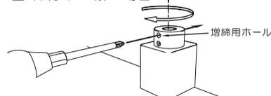
図の様にドライバーなどを増締め用ホールに差し込み右回転で回し締めつけてください。締めすぎると取付面が傷ついたり、クランプの破損などの原因になります。
